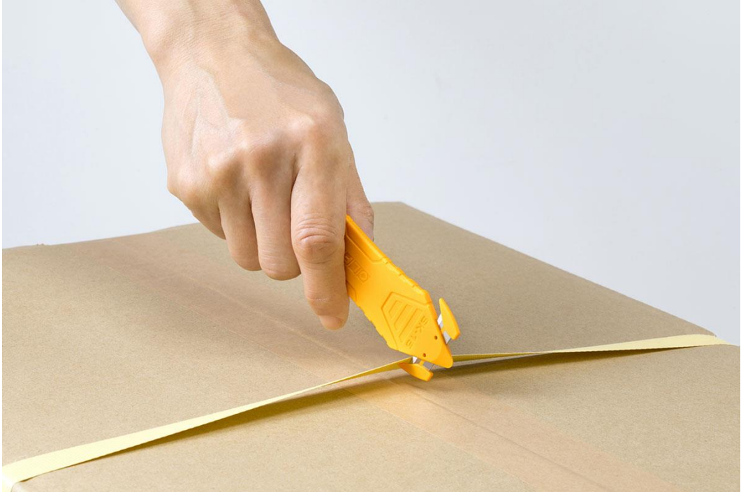
开捆用刀具“开捆”采用手指不易碰到刀刃的设计
